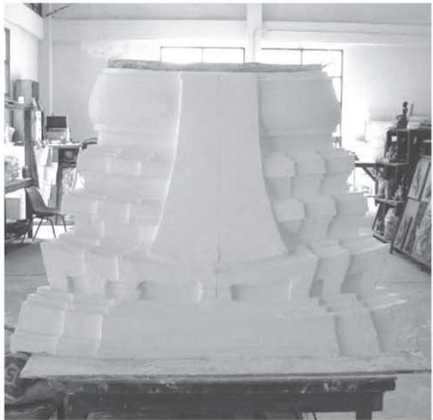
หุ่นแทนฐานที่ได้รับการหล่อรูปด้วยปูนปลาสเตอร์แล้ว
