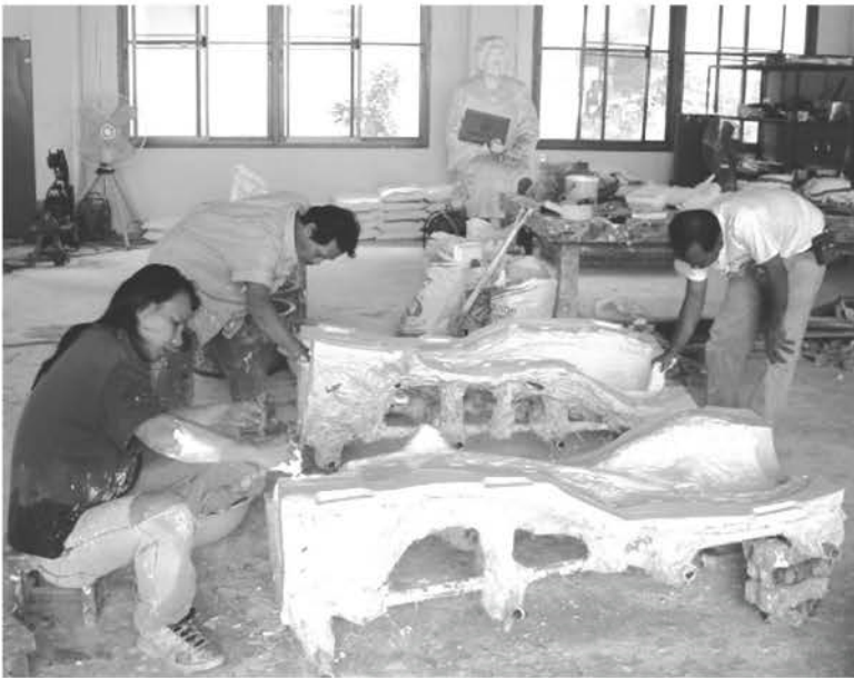
ผสมเนื้อปูนปลาสเตอร์ลงในแม่พิมพ์ประกอบพิมพ์และกรอกเนื้อปูนเพิ่ม สำหรับหุ่นปูนที่หล่อสำเร็จและส่งให้กลุ่มงานช่างหุ่นและปั้นลาย กลุ่มประณีตศิลป์ ดำเนินงานต่อไป
