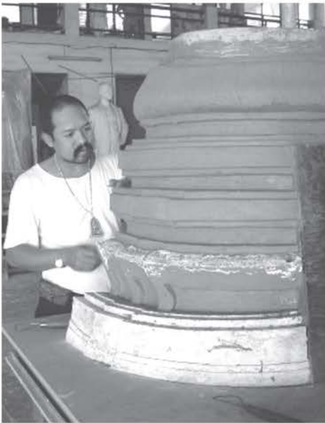
ปั้นหุ่นให้สมบูรณ์สวยงามตามแบบด้วยดินเหนียว
