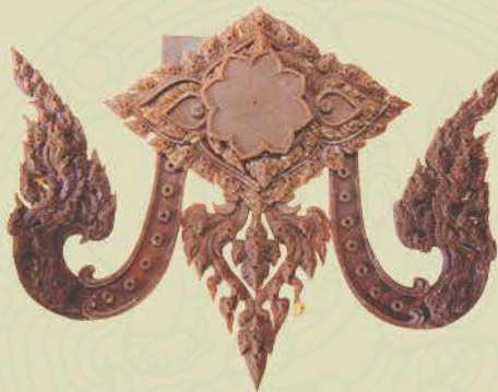
ลวดลายขี้ผึ้งประกอบองค์เตรียมหล่อด้วยโลหะ
