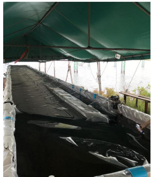
ภาพที่ 3-15-การลดปริมาณความเข้มข้นของสารละลายเกลือลงโดยทำความสะอาดผิวของไม้และทำการตรวจวัดปริมาณสารละลายเกลือในน้ำที่แช่
