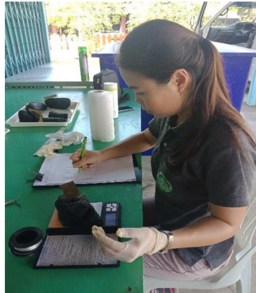
ภาพที่ 3-7-การตรวจเช็คความเข้มข้นของสารละลายที่ใช้ในการแช่ และการชั่งน้ำหนักของไม้เพื่อดูการเปลี่ยนแปลง
