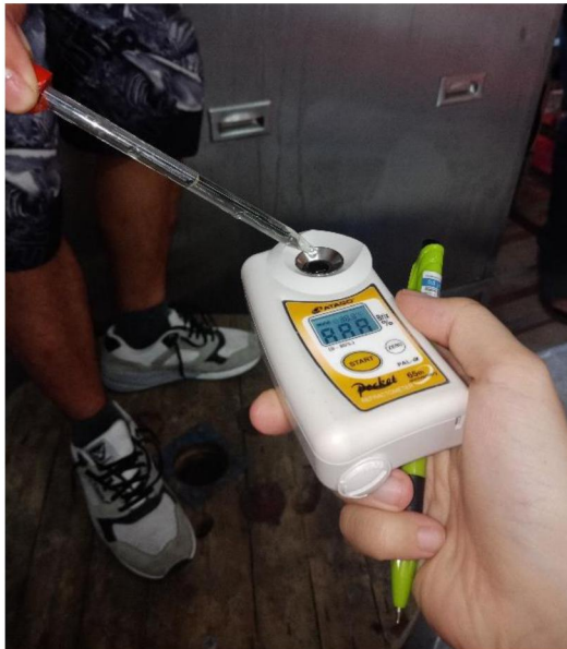
ภาพที่ 3-7-การตรวจเช็คความเข้มข้นของสารละลายที่ใช้ในการแช่ และการชั่งน้ำหนักของไม้เพื่อดูการเปลี่ยนแปลง
