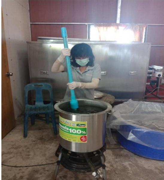
ภาพที่ 3-6-ดำเนินการเพิ่มความเข้มข้นของสารละลายเทรฮาโลส ที่ใช้ในการแช่ (Treatment) ไม้
