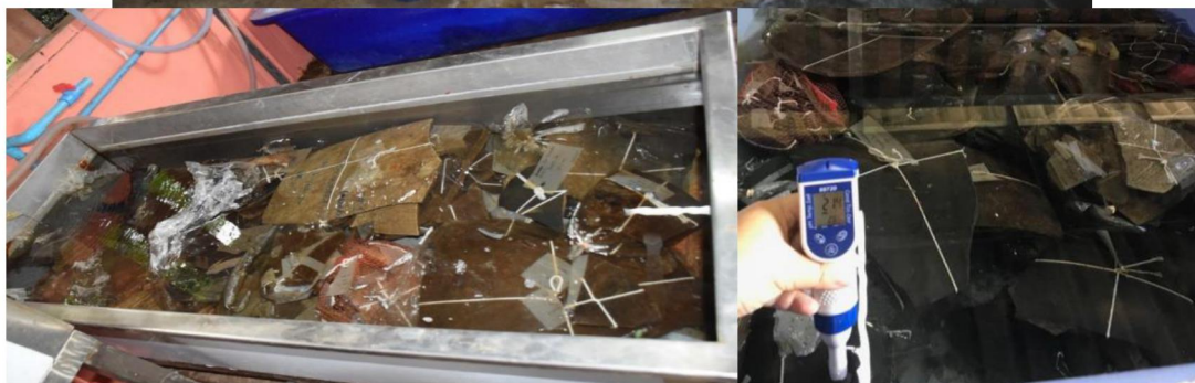
ภาพที่ 3-11-การลดปริมาณสารละลายเกลือในตัวอย่างภาชนะดินเผา โดยนำไปแช่ในน้ำกรองแล้วทำการตรวจวัดค่าสารละลายน้ำ
