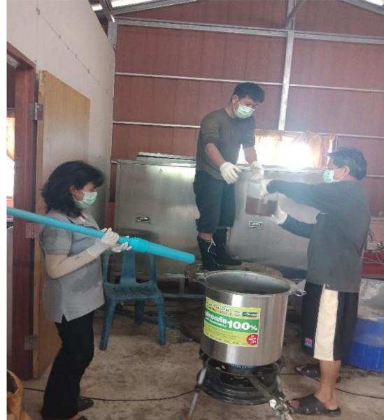
ภาพที่ 3-6-ดำเนินการเพิ่มความเข้มข้นของสารละลายเทรฮาโลส ที่ใช้ในการแช่ (Treatment) ไม้
