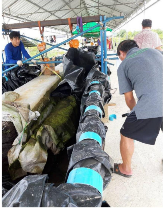
ภาพที่ 3-13-การปู่อซีเมนต์แช่ไม้ที่กระดุกงและเสากระโดงเรือด้วยพลาสติก
