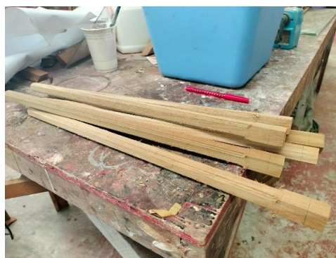
การไสบังใบมุมไม้ ให้เป็นควมมุมย่อไม้สิบสอง
