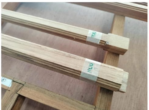
การทำเดือยโครงสร้างไม้ต้นเสา
