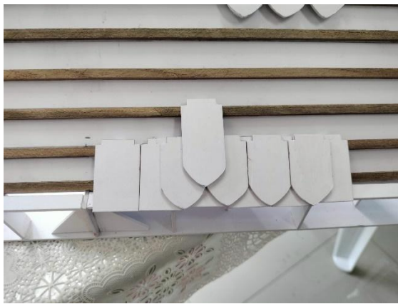
ภาพแสดงการทดสอบจัดวางปูกระเบื้องหลังคา แบบจำลอง
