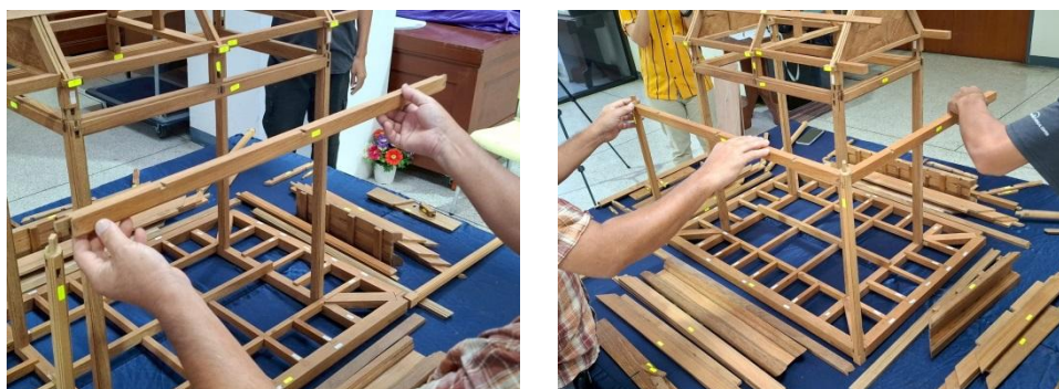
ขั้นตอนการเข้าและถอดประกอบโครงสร้างเชิงชาย
