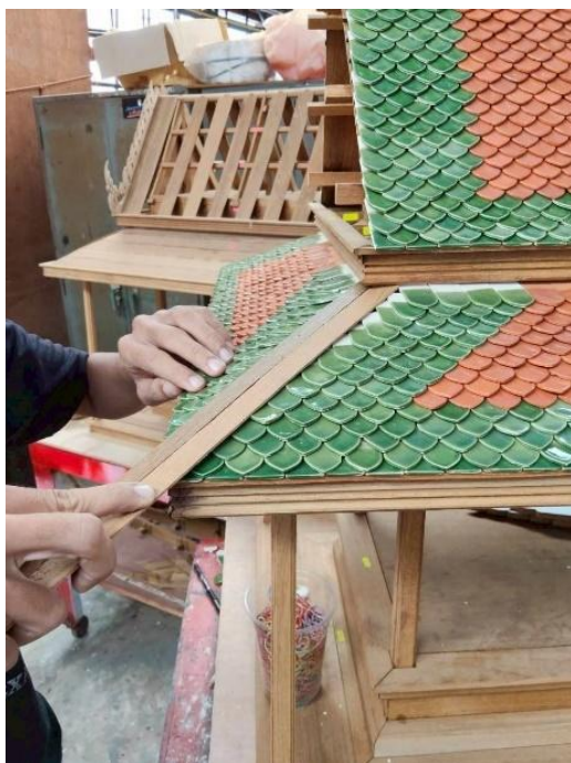
ขั้นตอนการประกอบสันตะเข้เชื่อมปิดมุมหลังคา
