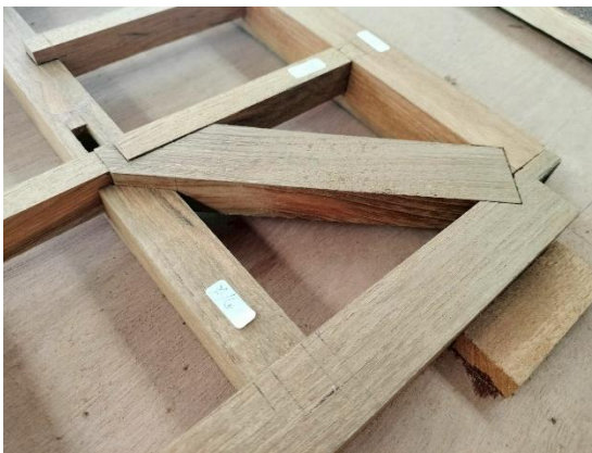
การทำไม้โครงสร้างจับบังคับมุมทั้ง ๔ ด้าน
