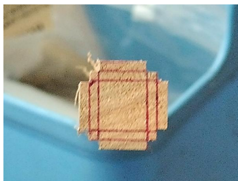
การไสบังใบมุมไม้ ให้เป็นควมมุมย่อไม้สิบสอง
