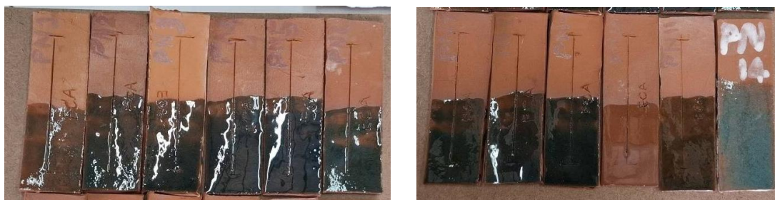
ภาพแสดงผลของสีเคลือบภายหลังการเผาของน้ำเคลือบชนิดต่างๆ
