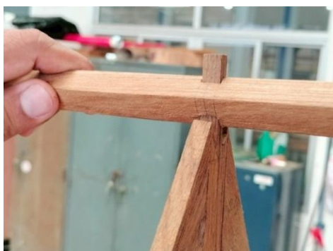
การประกอบโครงสร้างไม้เอกไก่อ
