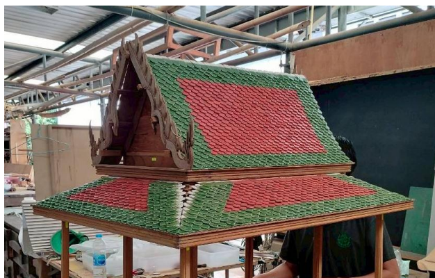
ขั้นตอนการปูกระเบื้องหลังคา
