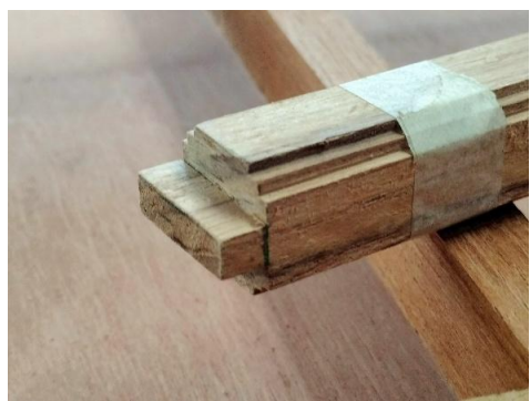
การทำเดือยโครงสร้างไม้ต้นเสา
