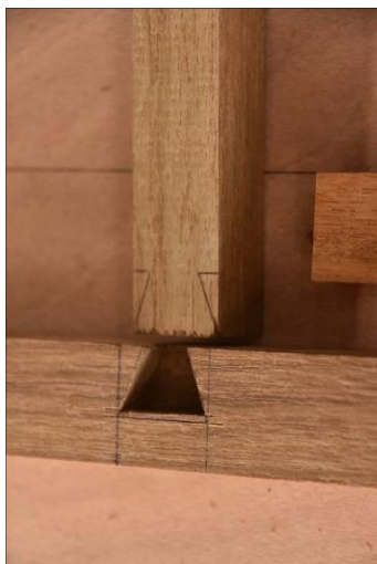
การแกะขุดและบากเดือย “หางเหยี่ยว” ในส่วนไม้กระถาง ไม้คาน ส่วนประกอบฐานล่าง
