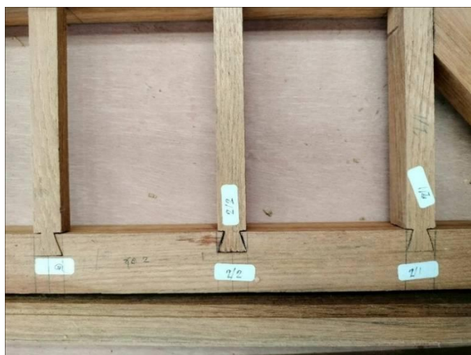
การแกะขุดและบากเดือย “หางเหยี่ยว” ในส่วนไม้กระถาง ไม้คาน ส่วนประกอบฐานล่าง
