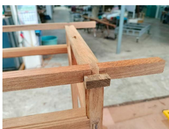
ประกอบแปรับหัวเสาเข้ากับซื่อ ด้านซ้ายและขวา
