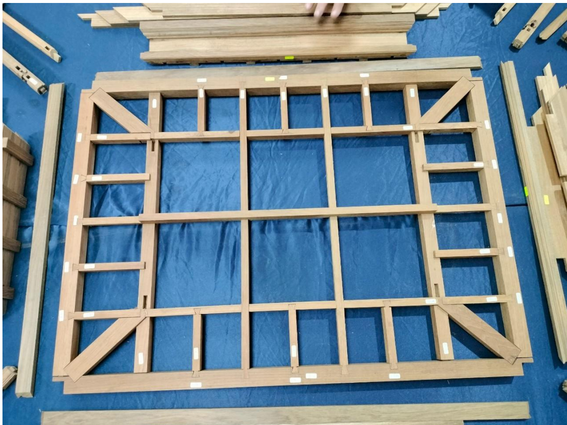
โครงสร้างไม้ส่วนฐานล่าง
