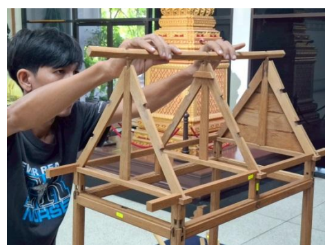
การประกอบโครงสร้างไม้เอกไก่อ
