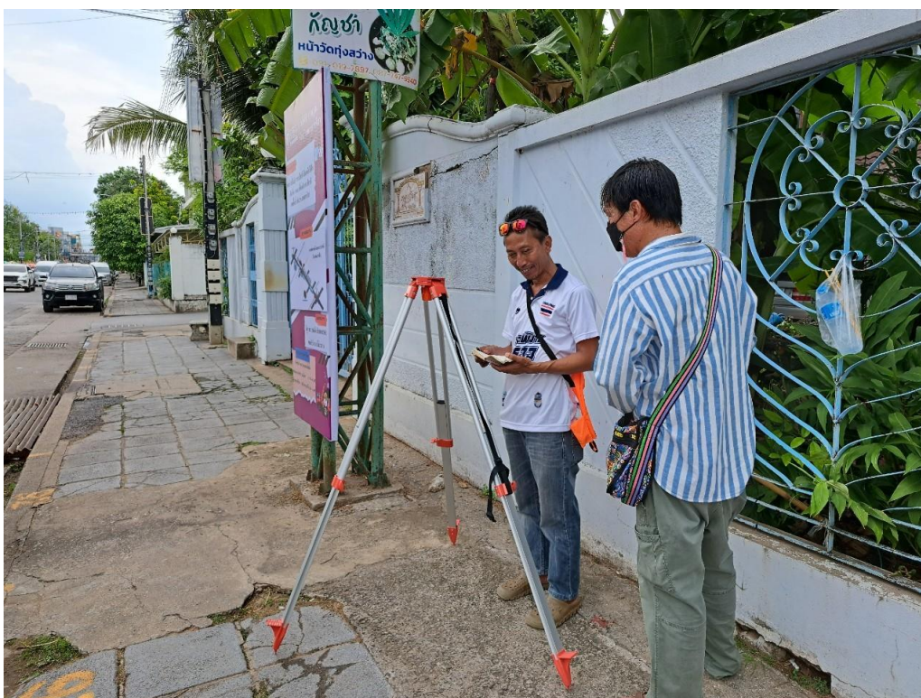
ภาพที่ 3.10 ส่องกล้องระดับเพื่อค่าระดับอ้างอิงมาตรฐานของหลุมชุดคันเปรียบเทียบกับค่าระดับอ้างอิงมาตรฐานของแหล่งกับหลุมชุดคันทั้ง 5 หลุม
