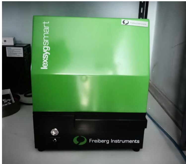
รูปที่ 1.4 เครื่อง Thermoluminescence Detector (TLD) ที่ใช้ในการกำหนดอายุ รุ่น lexysmart – Automated TL/OSL Reader ผลิตโดยบริษัท Freiberg Instruments ประเทศเยอรมนี
