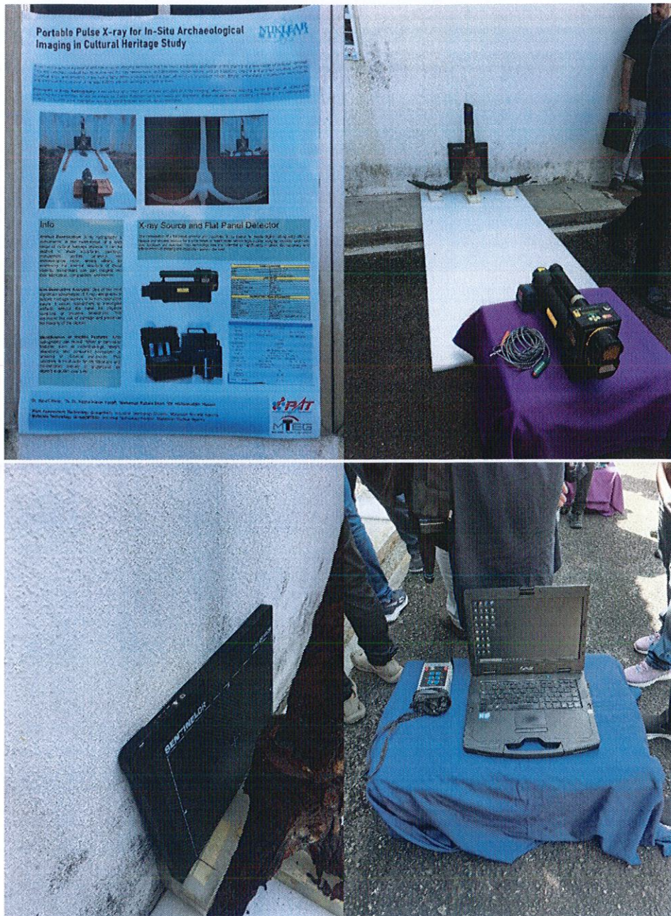
รูปที่ 12 เครื่องถ่ายภาพเอ็กซเรย์ภาคสนามแบบพกพา
