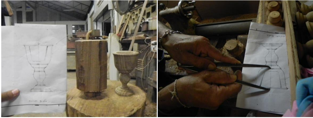
แบบพุ่มสำหรับให้ช่างกลึงใช้เป็นแบบในการจัดทำหุ่น
