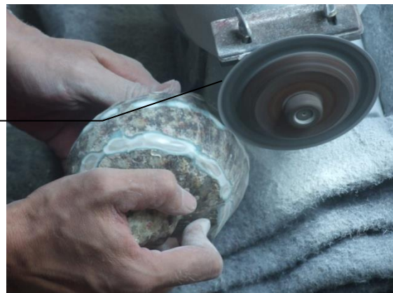
มอเตอร์ตัดใบตัดใช้สำหรับตัดแบ่งชิ้นหอย และสร้างลวดลายบางประเภท
