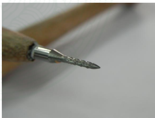
นำเอาส่วนเจาะกระจกมาเจียรปลายให้แหลมคม นำมาใช้ตัดกระจก
