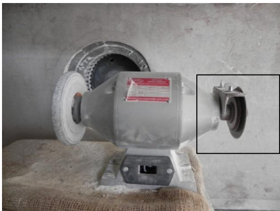
มอเตอร์ตัดใบตัดใช้สำหรับตัดแบ่งชิ้นหอย และสร้างลวดลายบางประเภท
