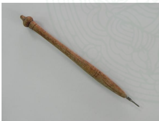
นำเอาส่วนเจาะกระจกมาเจียรปลายให้แหลมคม นำมาใช้ตัดกระจก
