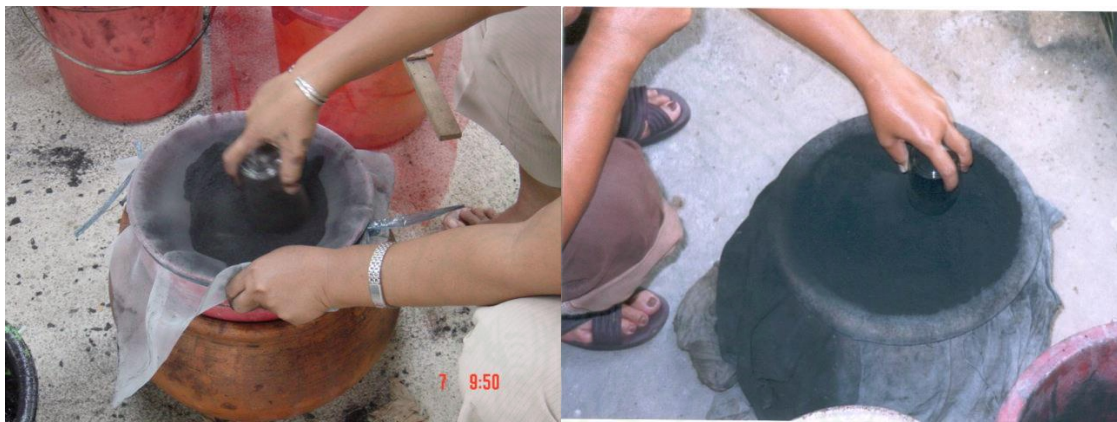
การกรองสมุกเพื่อใช้งานโดยใช้ผ้าซิลิสกรีนเบอร์ละเอียด
