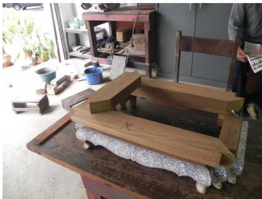
จัดทำส่วนฐานของกระบะในลักษณะการเข้าไม้ให้ได้ตามแบบลักษณะการเข้ามุ่มย่อมุมไม้สี่บสอง
