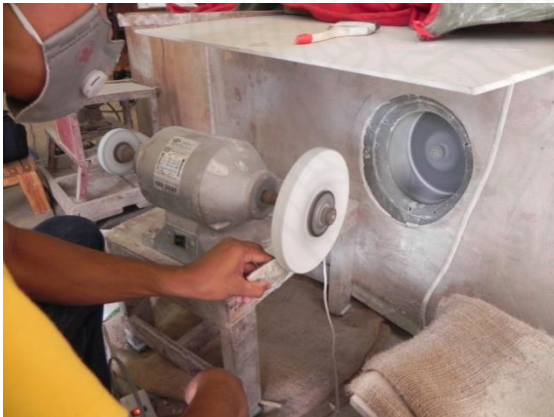
มอเตอร์ติดหินเจียรสำหรับขัดลอกเปลือกหอย
