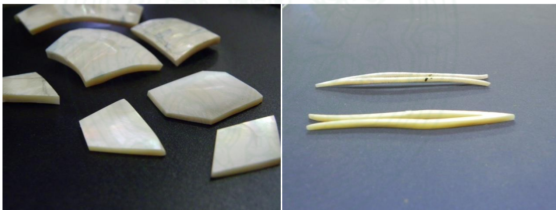
ภาพเปรียบเทียบชิ้นหอยที่ทำให้เป็นแผ่นตรง นำมาฉลุเป็นลายเพื่อใช้งานตรงยาว
