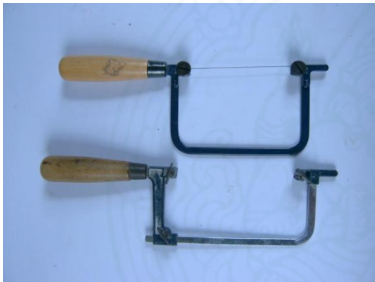
เครื่องเลื่อยที่ใช้ในการโกกรกฉลุมุก
