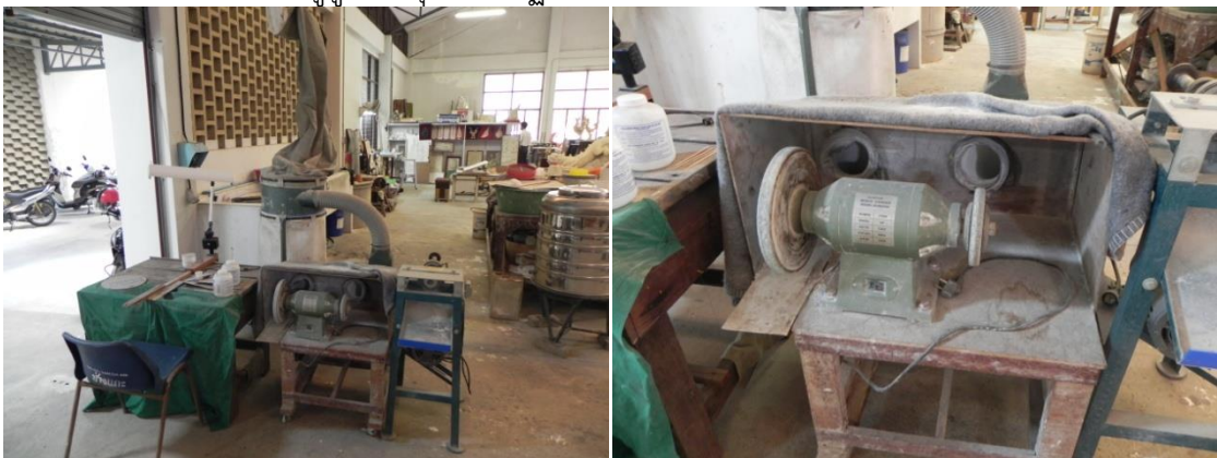
ทำตู้ดูดเก็บฝุ่นขณะปฏิบัติงานขัด ตัด เจียรเปลือกหอย
