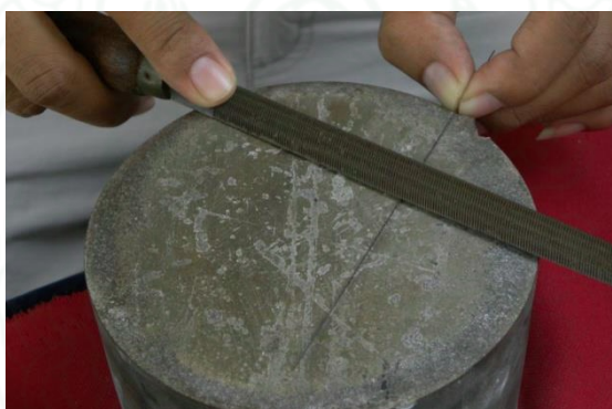
ตะไบในการตีใบเลื่อยฉลุไม้
