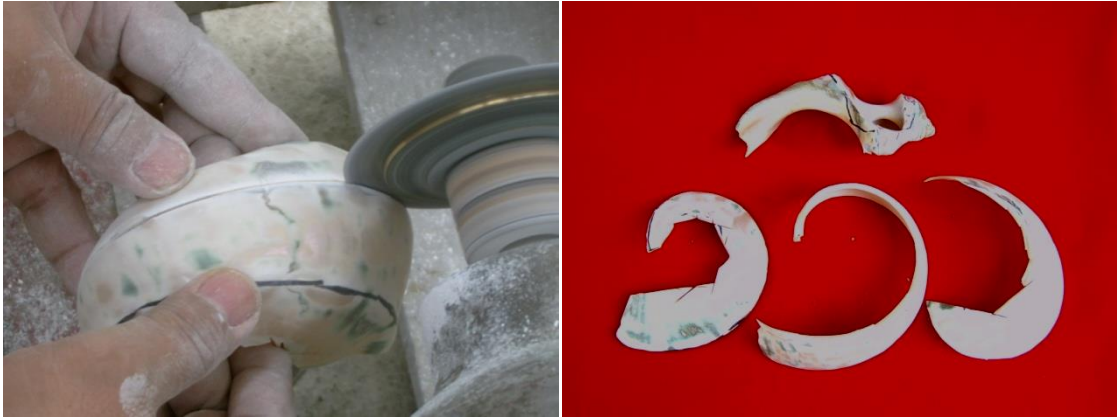
ชิ้นหอยที่ทำการตัดแบ่งหอย ๑ ตัวจะตัดแบ่งได้ ๓ ส่วน
