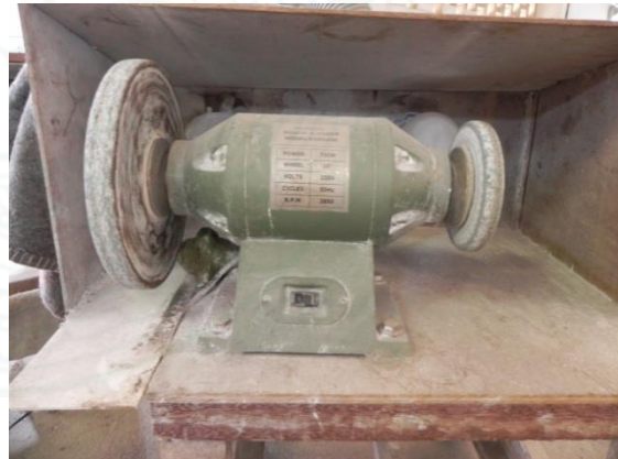
มอเตอร์ติดหินเจียรสำหรับขัดลอกเปลือกหอย
