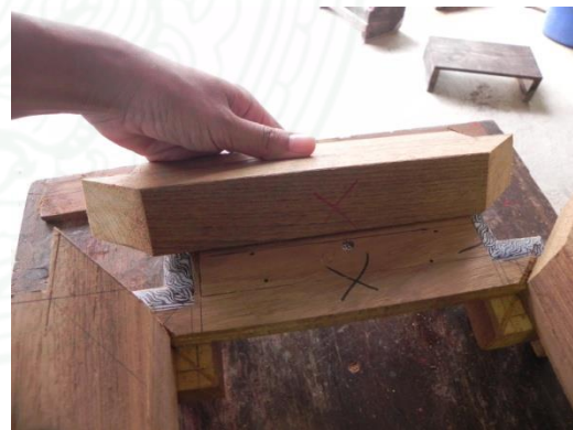
จัดทำส่วนฐานของกระบะในลักษณะการเข้าไม้ให้ได้ตามแบบลักษณะการเข้ามุ่มย่อมุมไม้สี่บสอง
