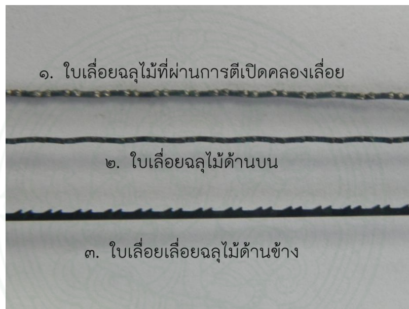
เปรียบเทียบใบเลื่อยฉลุไม้ก่อนและหลังการตีคัดคลองเลื่อย
