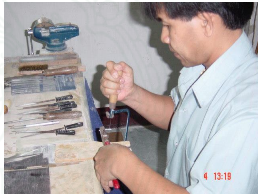
เครื่องเลื่อยที่ใช้ในการโกกรกฉลุมุก
